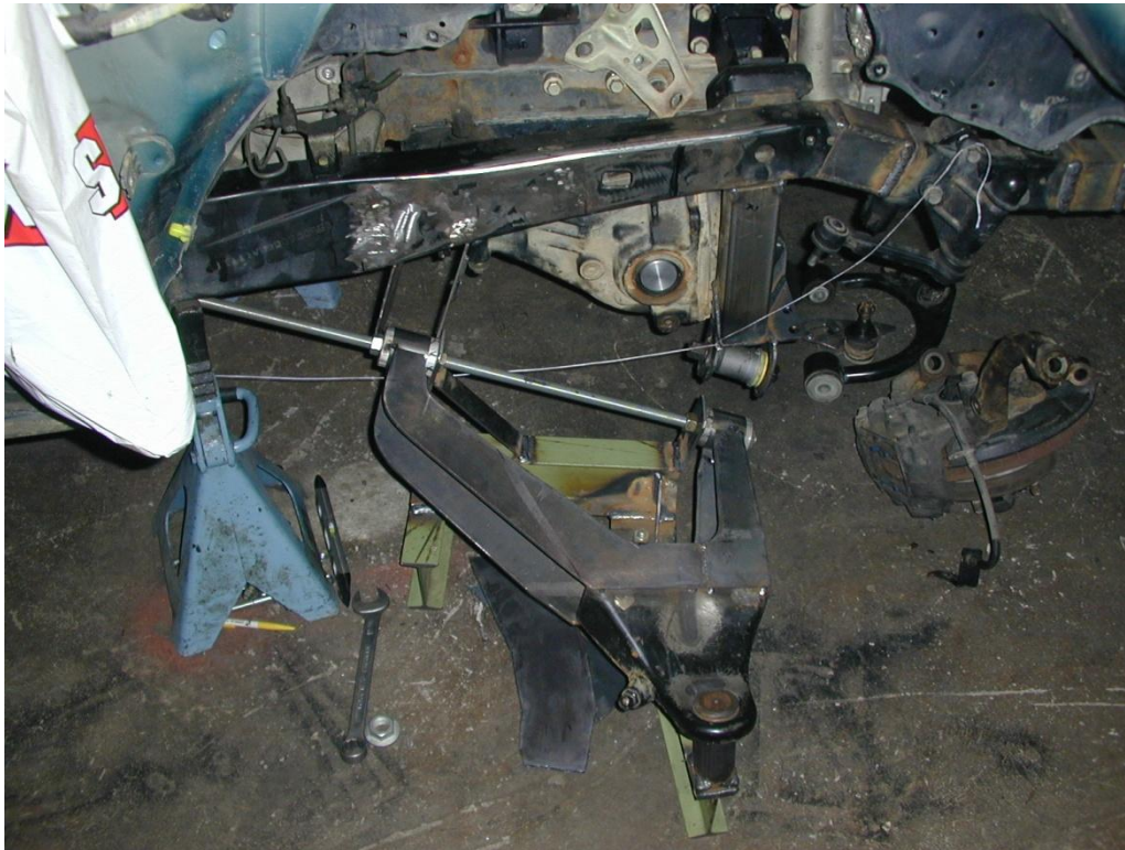
Trapèze AVD en construction
